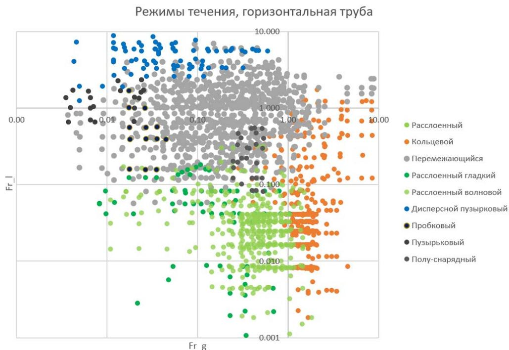
Рис. 4. Диаграмма режимов течения в безразмерных координатах
