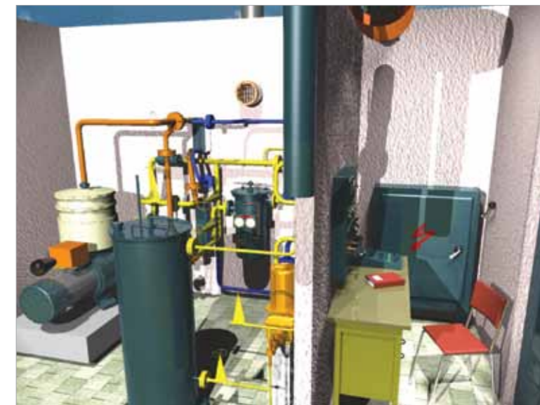
▲ Один из первых проектов АО «ИПН» в 3D. Фотореалистическая 3D модель малогабаритного производственного модуля обработки дизельного топлива «ДИТО». Выполнен в MicroStation и OMNI-Pipe в 1998 году
