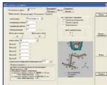
▲ Рис. 4. Расчет вертикальной врезки (бесканальная прокладка)
