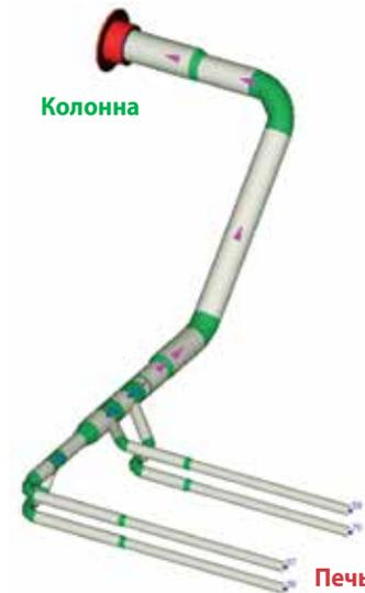
Рисунок 2 – Короткий трансферный трубопровод с минимальным количеством плавных поворотов – оптимальная конфигурация
