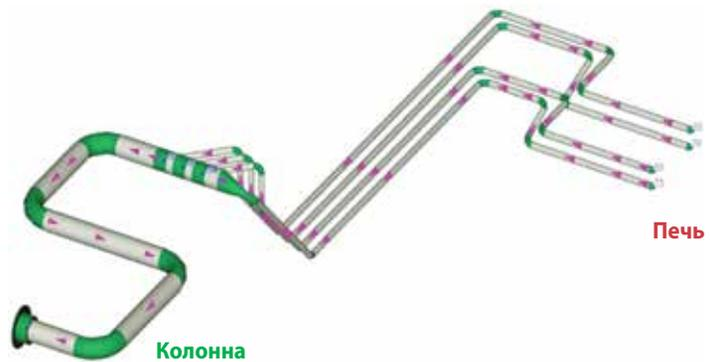
Рисунок 1 – Длинный и извилистый трансферный трубопровод, работающий в режиме СНВ
