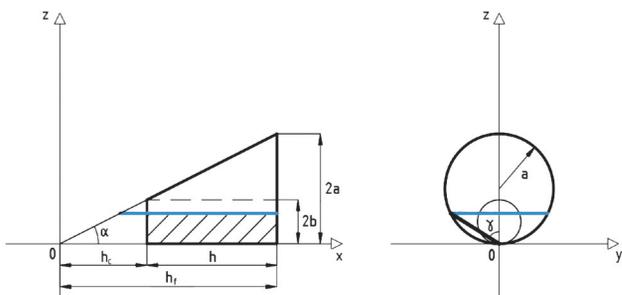
Рисунок 3 – Параметры эксцентрического конуса
