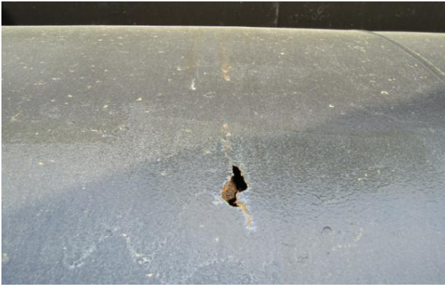
Фото 18. РГС-200 сквозное повреждение корпуса
