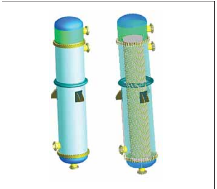
Рис. 4. Вертикальный аппарат с компенсатором
